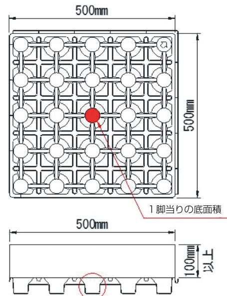
※ 湧水パネル下部の凸部(赤枠部分)を脚と呼びます。(1㎡当り100脚)
