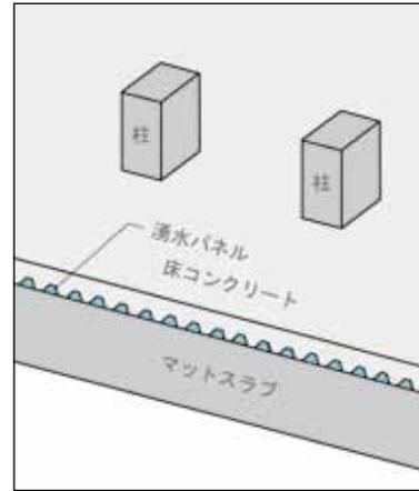
せせらぎ工法の採用でマットスラブ構造が可能となり…
