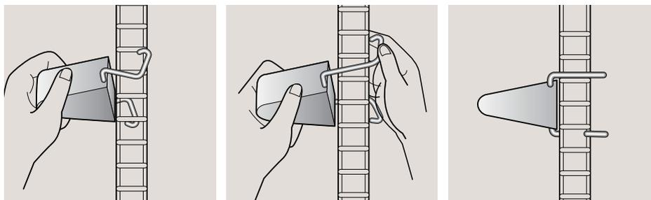
片側の金具を先にセットします。もう片側を回転して上曲げを押しと簡単に入ります。 セット完了
