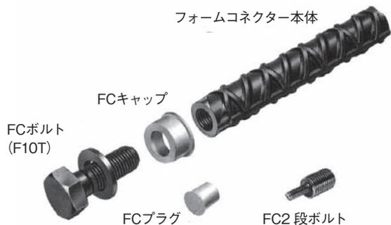
FC2段ボルトをフォームコネクターの仮止めに使用すれば、メタルフォーム面板の穿孔径がW3/8のバカ穴ですみ補修が容易です。
