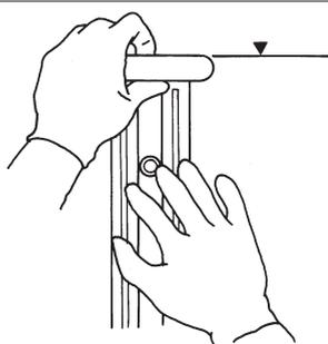
丸セパにステップタイを差し込み端太角のレベルに合わせます。
