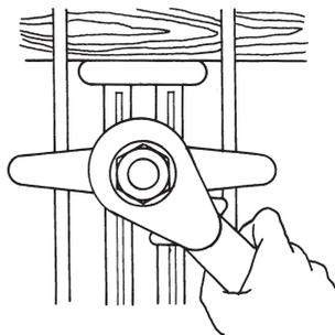
端太角を載せアームを起こして、3型座金で締め付ければ完了です。
