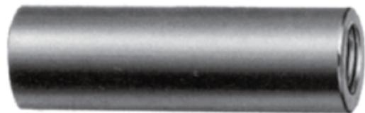
鉄骨にプロジェクトナットを溶接し、その雌ねじ (W5/16、W3/8) を利用してセパレーターを取付けます。
