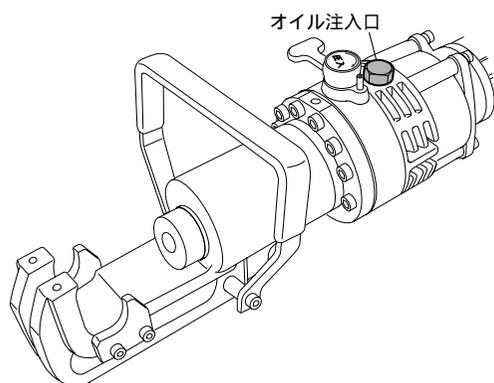
注油口が上向きになるように、本機を台などに置き、水平に安定させてください。
