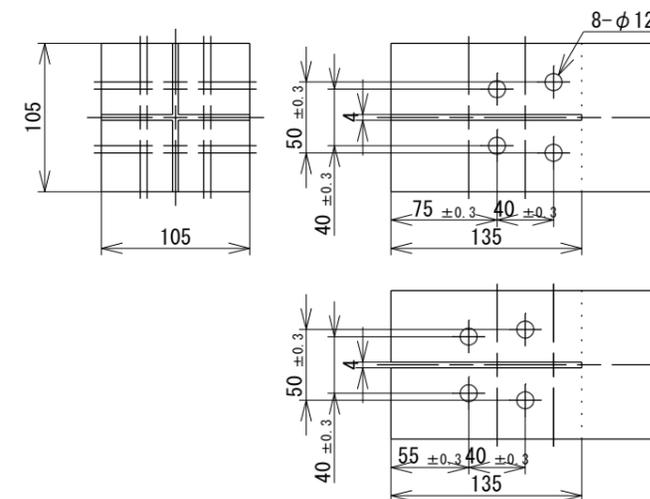
柱加工図 断面120×120
