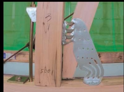
従来の金物は1回の加振で筋かいが大きく破損しています。一方、ブラスターZ600は6回にわたる加振後も、金物が変形することにより木材の損傷を防止しました。
