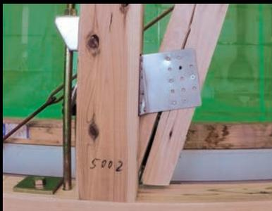
1回目で筋かいに亀裂が入り試験終了
