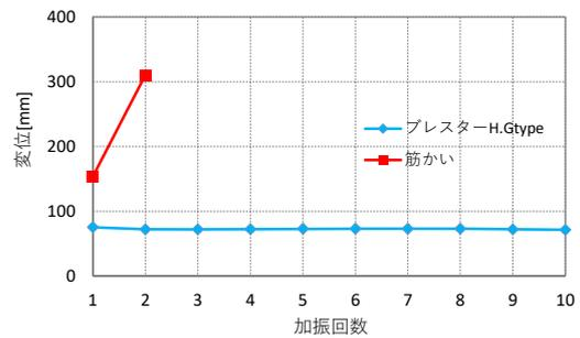
図 1.5 加振回数と壁の変形量
