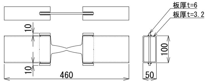
鋼材：SN400B【JIS G 3136（2012）建築構造用圧延鋼材】
