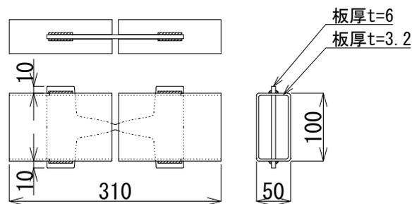
鋼材：SN400B 【JIS G 3136（2012）建築構造用圧延鋼材】
