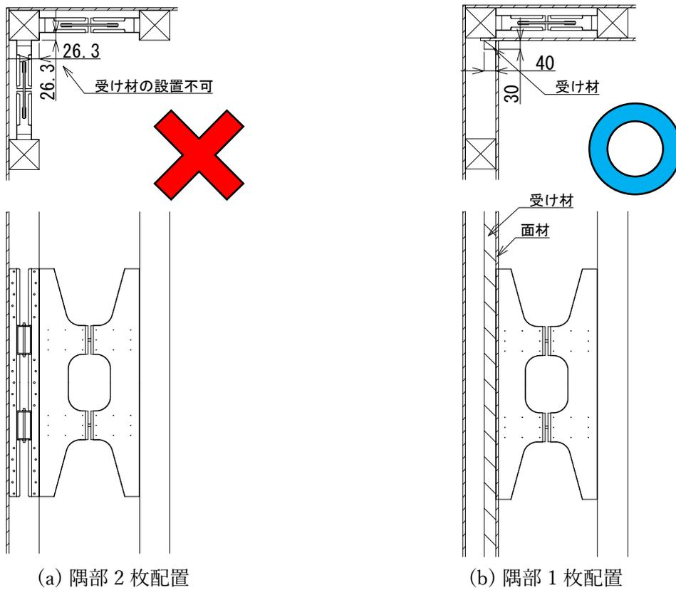
図 3.5 隅部の柱への本製品の取付け例
