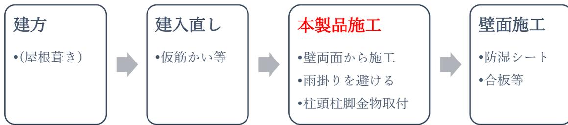
※本製品の施工は壁の両面から行ないます。取付け前に壁を塞がないようご注意ください。
