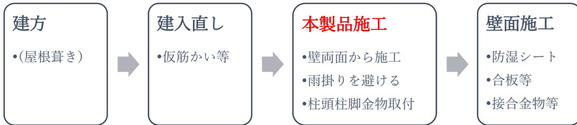
※本製品の施工は壁の両面から行ないます。取付け前に壁を塞がないようご注意ください。
