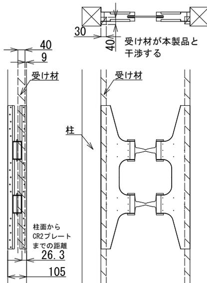
図 3.3 本製品と受け材の干渉
