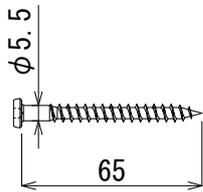
鋼材：SWCH【JIS G 3507-2（2005）冷間圧造用炭素鋼-第2部：線】
