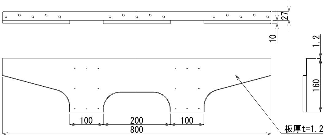
鋼材：SGHC または SGCC 【JIS G 3302（2019）溶融亜鉛めっき鋼板及び鋼帯】
