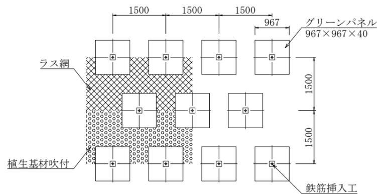
鉄筋挿入工 詳細図 S=1/10
