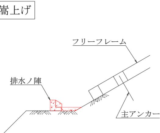
嵩上げ (側溝併用例)
