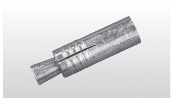
○本体打込み式は、アンカー本体の拡張部にテーパ付コーンを事前にセットし、もう一方の本体端部を専用打込み棒を用いて打込むことにより、拡張するアンカーです。
