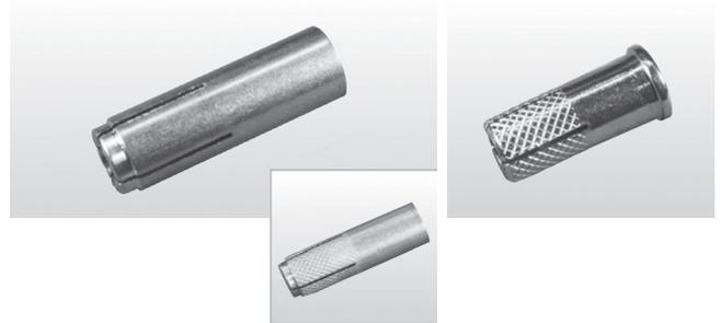
○内部コーン打込み式は、本体に内蔵しているコーンを専用打込み棒を用いて打込むことにより、コーンが本体末端部を拡張させるアンカーです。
