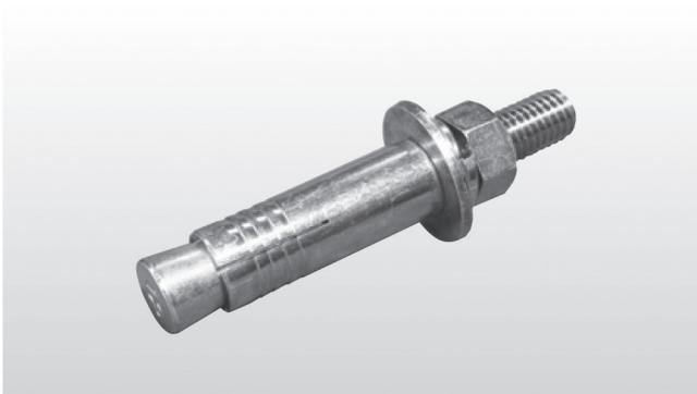
○スリーブ打込み式は、スリーブ、テーパ付ボルトから構成され、スリーブの一端を専用打込み棒を用いて打込むことにより、スリーブがテーパ部に沿って拡張するアンカーです。
